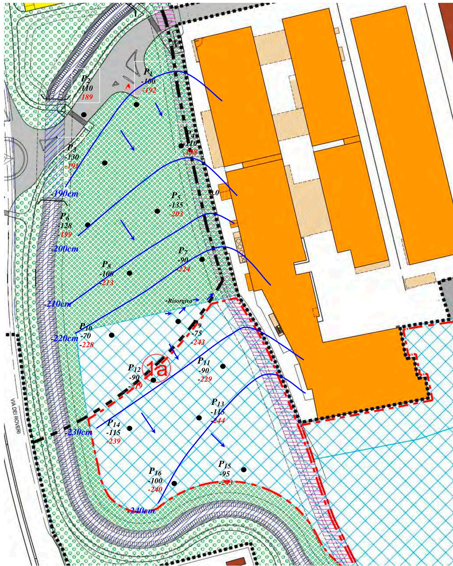
**TAV.6 : Carta Idrogeologica con indicazione di profondità del livello di falda dal p.c. e da 0.0. rilevato il 09.04.14 e linee isofreatiche con direzioni dei deflussi sotterranei**
